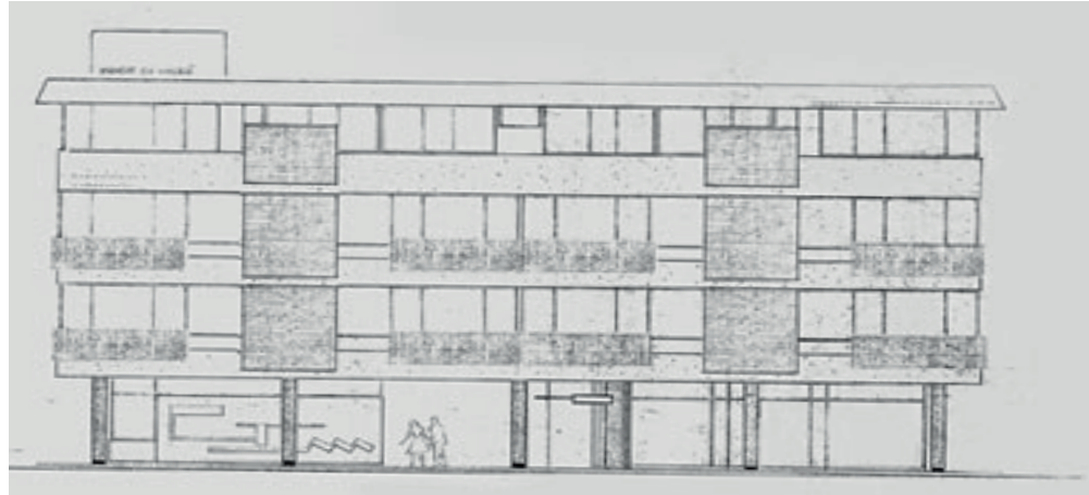
Şekil 11. 1972 tarihli tadilat projesinde eklenen dördüncü kat (Güney ve Tulum, 2021).
